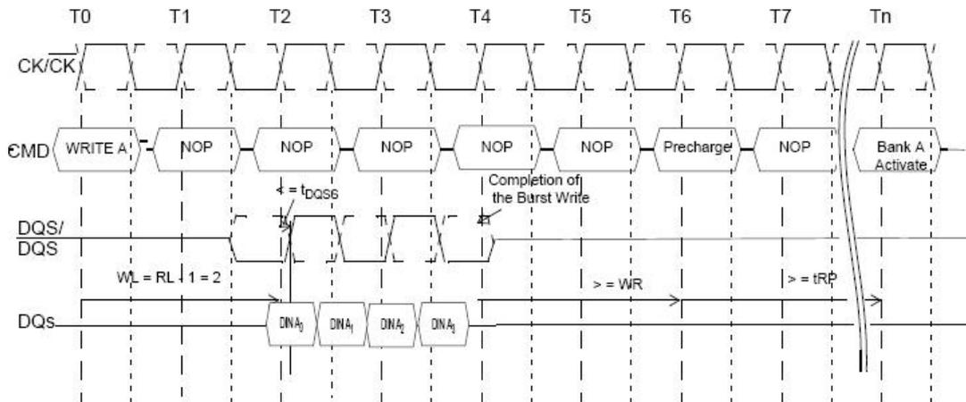
图 9-2 DDR2 SDRAM 写操作协议
