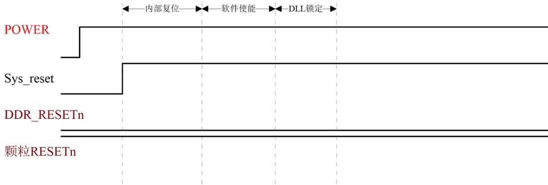
由后两种复位模式相配合，就可以直接在使用内存控制器的复位信号的情况下实现 STR 控制。当整个系统从关闭状态下启动时，使用（2）中的方法来使用内存条正常复位并开始工作。当系统从 STR 中恢复的时候，使用（3）中的方法来重新配置内存条，使得在不破坏内存条原有状态的条件上使其重新开始正常工作。
