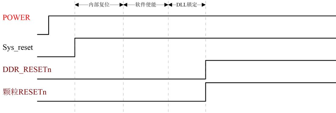
(2) 反向模式，`reset_ctrl[1:0] == 2' b10`。这种模式下，复位信号引脚在进行内存实际控制的时候，有效电平与一般的控制模式相反。所以主板上需要将 DDR\_RESETEn 通过反向器与内存槽上的对应引脚相连。引脚的行为是：
