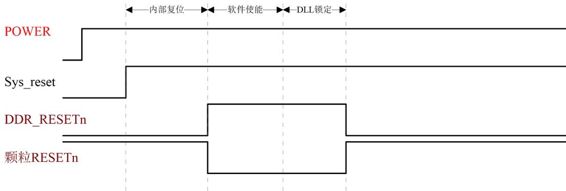
(3) 复位禁止模式，`pm_reset_ctrl[1:0] == 2' b01`。这种模式下，复位信号引脚在整个内存工作期间，保持低电平。所以主板上需要将 DDR\_RESETEn 通过反向器与内存槽上的对应引脚相连。引脚的行为是：
