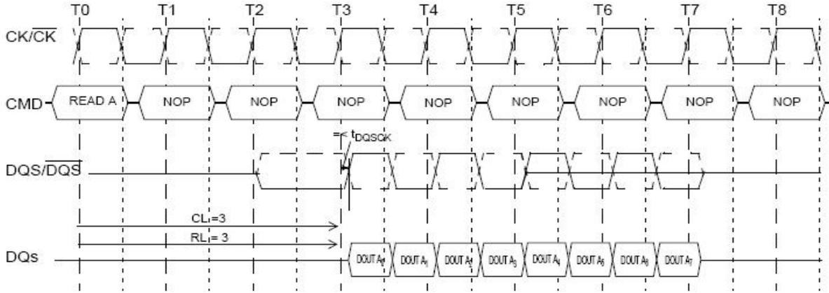
图 9-1 DDR2 SDRAM 读操作协议
