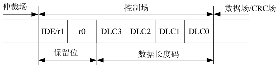
图 17.1 CAN 总线协议中数据帧格式
