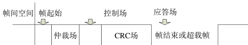
图 17.2 CAN 总线协议中远程帧格式
