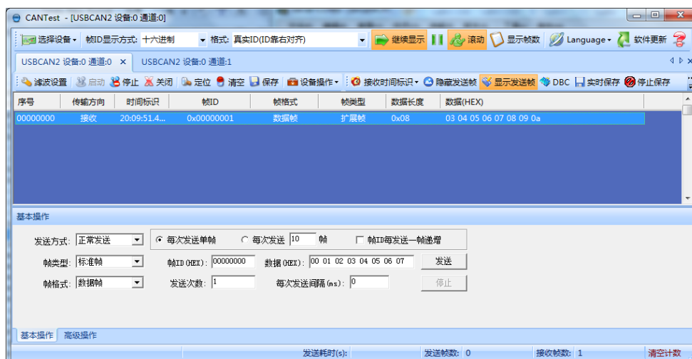
图 17.7 开发板发送 CAN 数据后上位机监控界面显示
