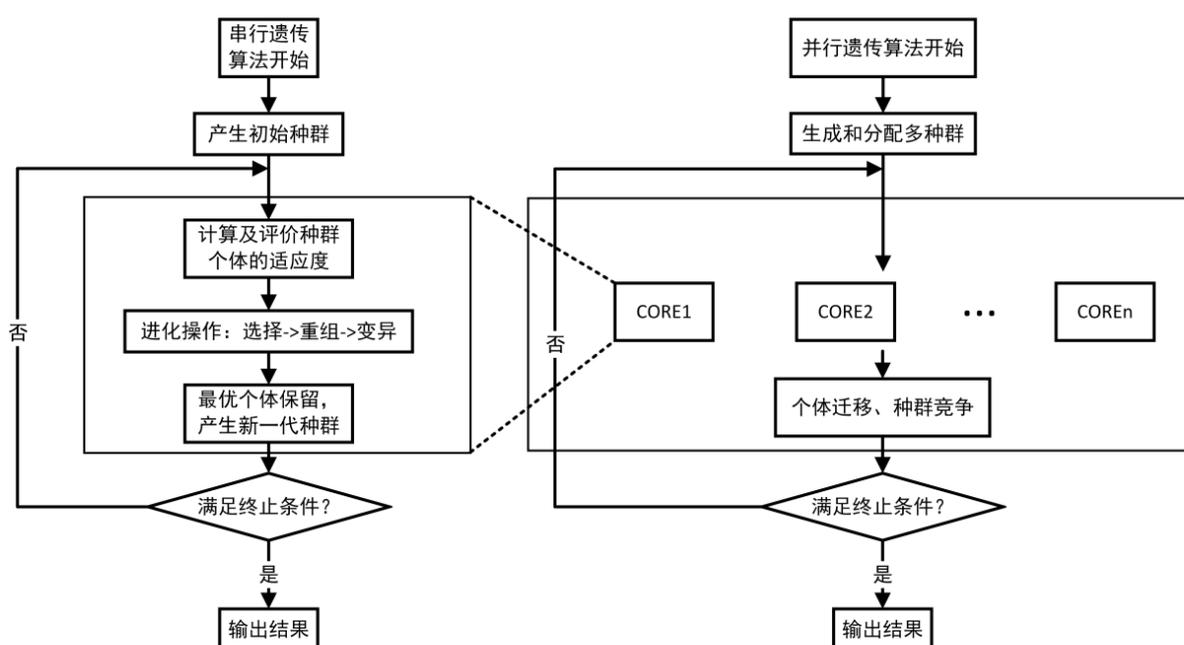
图中 $CORE_n$ 表示计算核心。不同的计算核心处理不同的单个子种群(当然也可以处理多个子种群)，种群间互相独立进行进化(区域模型)，种群间进行个体迁移和种群竞争。这只是其中一种并行计算遗传算法，另外还有全局模型和本地模型。
